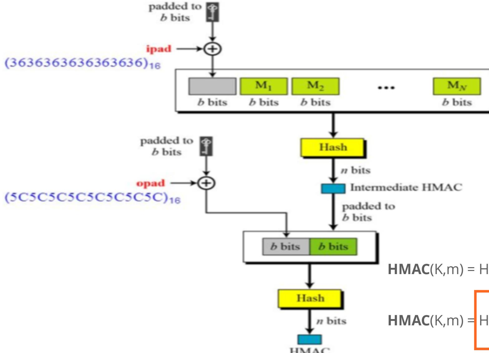
Se puede usar cualquier algoritmo de hash y concatenar la clave  $k$  y el mensaje a autenticar. De manera que luego ese sea el texto a ingresar en el hash. Su descripción se puede hallar en RFC 2104
