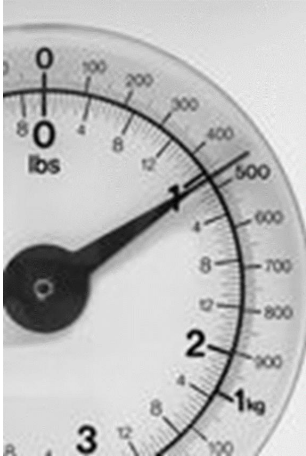
Instrumento ANALÓGICO (de “escala y aguja”)
