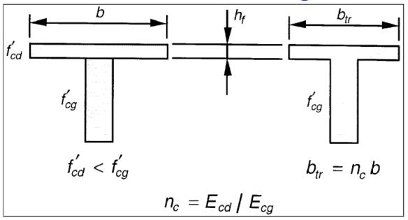
Ancho efectivo de losa - (LRFD 4.6.2.6.1) – para vigas interiores: el menor de ¼ del claro efectivo, 12 veces el espesor promedio de la losa + mayor del ancho del alma de la viga y ½ el ancho del patín superior; y el espacio promedio entre vigas adyacentes.
