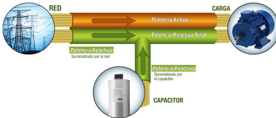
Figura 3.6 Condensador de compensación
