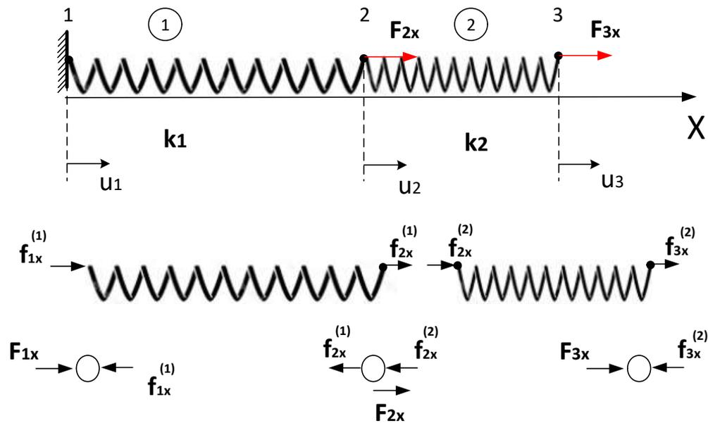
Figura 2.6 Diagrama de cuerpo libre de nodos y elementos.
