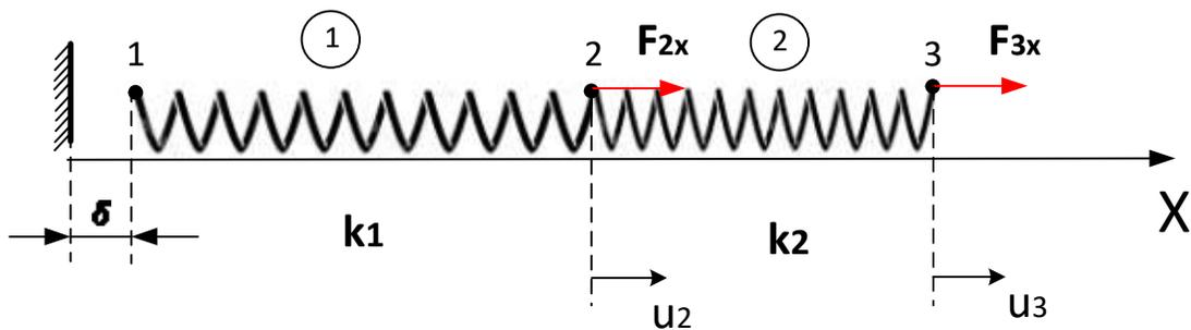
Figura 2.9 Ensamblaje de dos resortes con desplazamientos conocido para el nodo 1.
