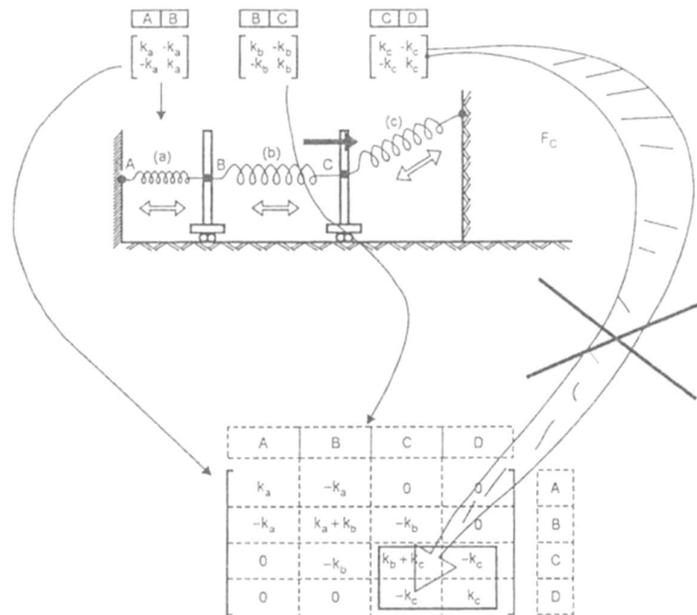
Figura 2.8 El montaje de la matriz de rigidez de elementos no alineados requiere la definición de los componentes de rigidez en la dirección de los desplazamientos. (Alves Filho 2018)
