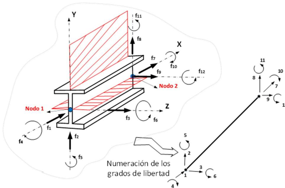
Figura 2.4 Elemento Viga en el caso más general admite en un mismo nodo, seis componentes de desplazamientos nodales, tres traslaciones y tres rotaciones.
