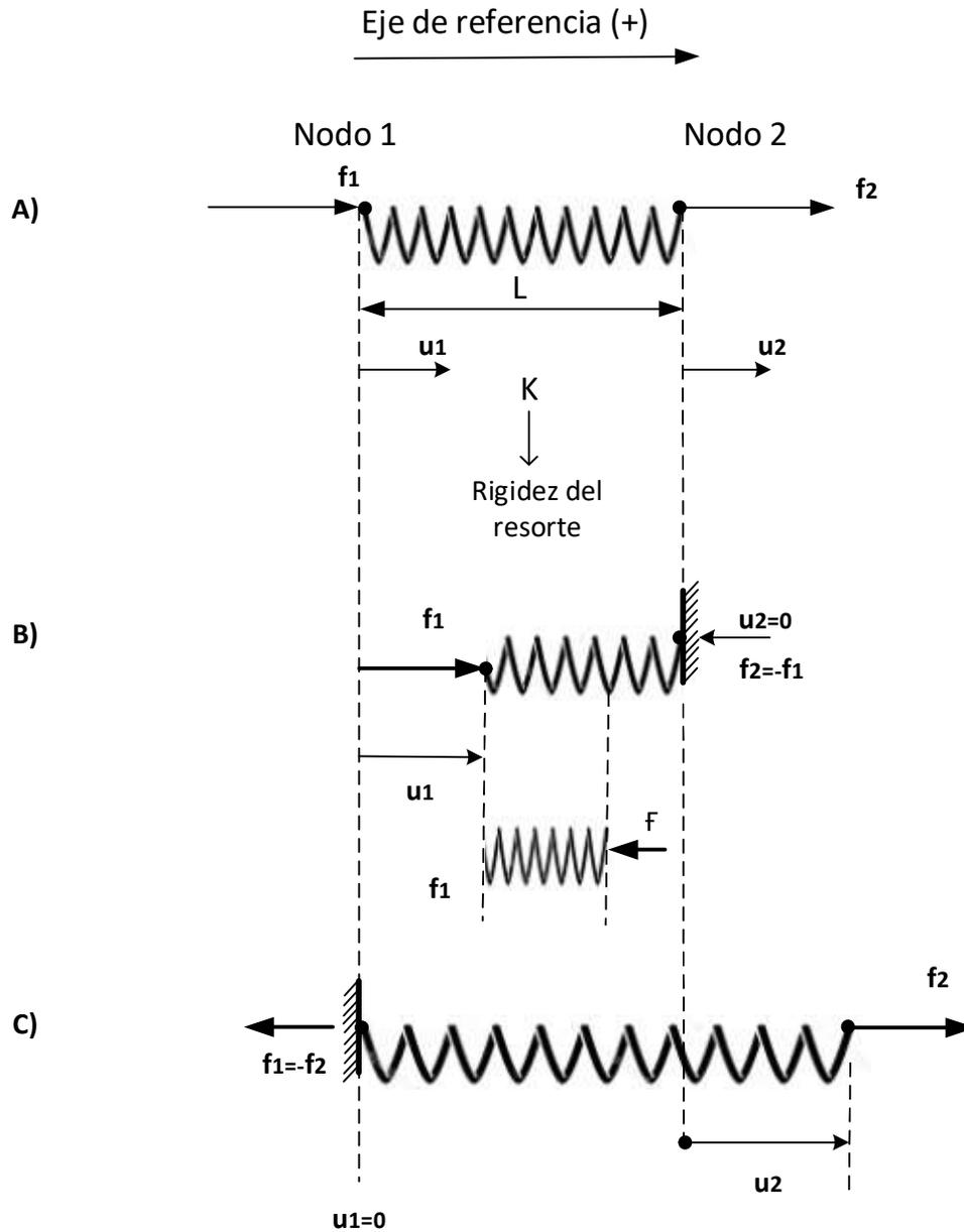
Figura 2.3 Diagrama de cuerpo libre de un elemento de resorte. En el caso B, el nodo 1 del elemento es sometido a un desplazamiento  $u_p$  manteniendo el nodo 2 bloqueado. En el caso C, tenemos la situación opuesta. Adaptado de (Alves Filho 2018)
