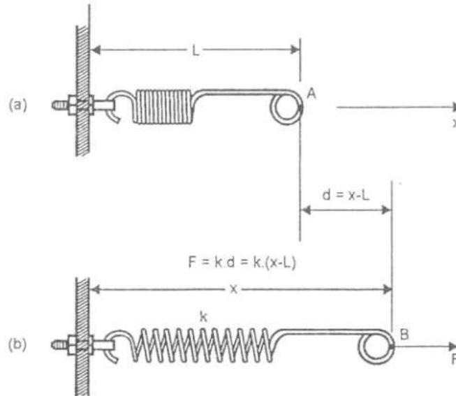
Figura 2.1 La rigidez del resorte puede ser representada por su constante elástica, o coeficiente de rigidez  $k$ . (Alves Filho 2018).
