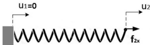
Restringimos algunos nodos de la estructura significa **aplicar condiciones de contorno**.
