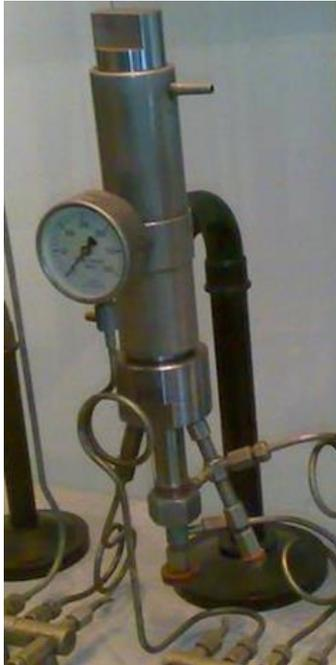
Entre otras cosas, el reactor tiene que soportar 150 bar que es una presión alta para las presiones con las que nos topamos en nuestra vida en la superficie de la Tierra.
