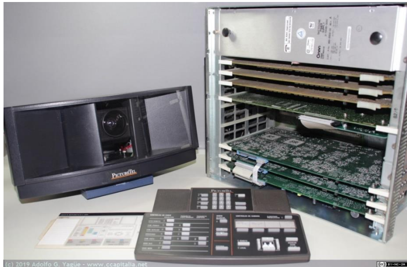
Figura 34: Equipo PictureTel System 4000, con Cámara, teclado y CPU Codec, tomado de [80].
