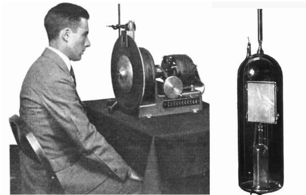
Figura 7: Una lámpara de neón (mostrada en detalle a la derecha de la figura) funciona con la corriente de la imagen e ilumina el disco, que tiene una serie de pequeñas aberturas. A medida que las aberturas atraviesan el campo de visión, la intensidad de la lámpara varía, y el observador recibe la imagen. Tomado de [5].
