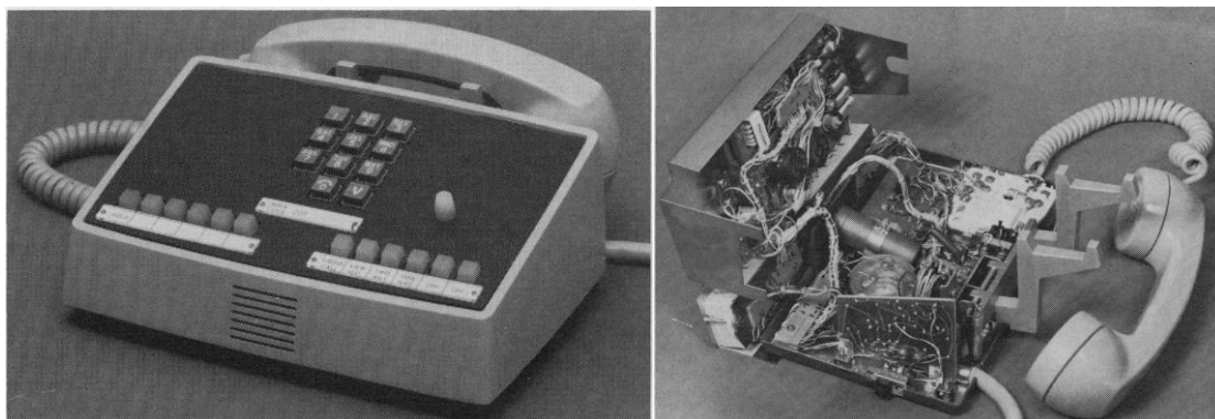
Figura 18: Unidad de control y teléfono, vista exterior y detalle interior. Tomado de [25].
