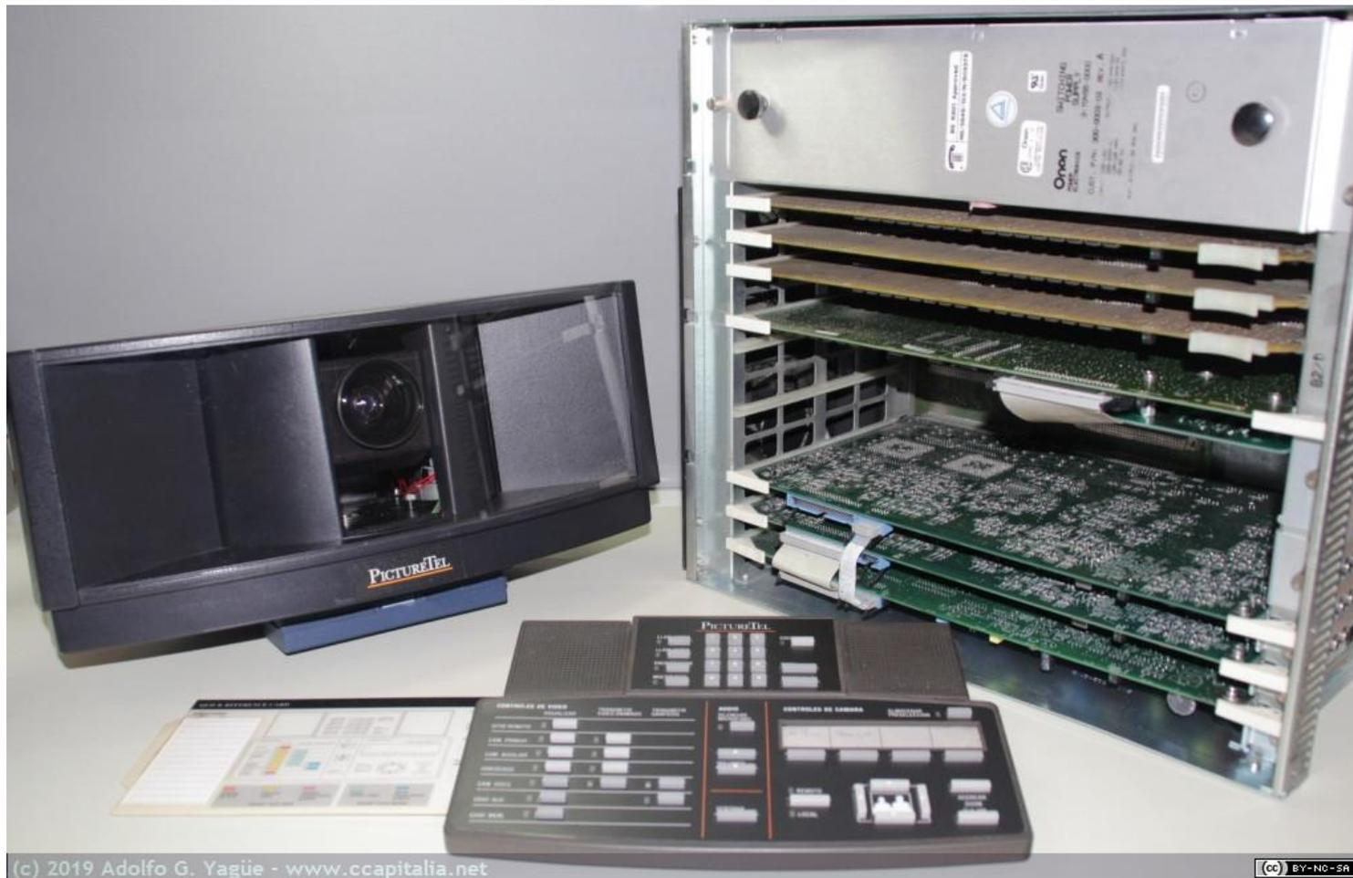
Equipo PictureTel System 4000, con Cámara, teclado y CPU Codec, 1991
