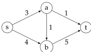
El corte  $(\{s, a\}, \{b, t\})$  tiene una capacidad de 6 y es mínimo. Sin embargo, al sumar 1 a cada arista, el mismo corte tiene capacidad 9 y sin embargo, un corte mínimo de esta nueva red,  $(\{s, a, b\}, \{t\})$ , es 8.
