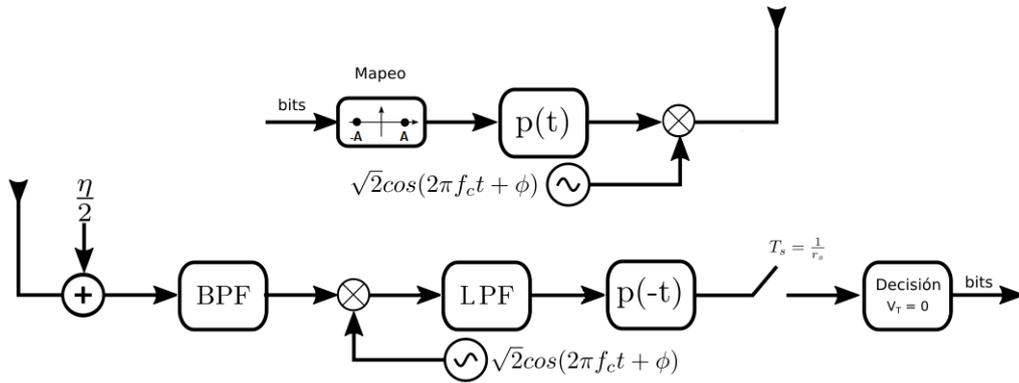
Figura 4: Diagrama de bloques del sistema BPSK
