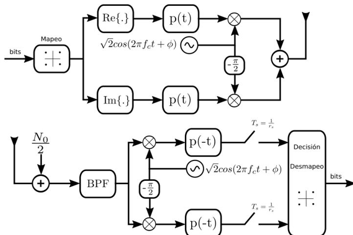
Figura 1: Transmisor y receptor de sistema QPSK
