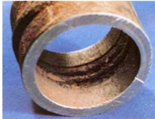
Corrosión ácida durante limpieza química
