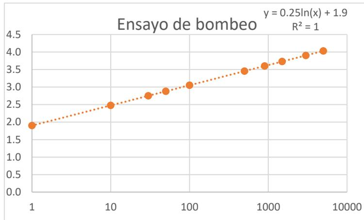
b) El  $s$  real para un caudal dado, se estima a partir de la curva característica del pozo. La cual se obtiene a partir del ensayo de tres escalones con caudal incremental.
