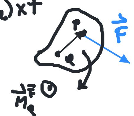
Otra alternativa: obtendremos una relación que permite evaluar directamente la acción de los momentos extraños sobre  $\vec{w}$ , sin tener que pasar por  $\vec{L}$  (por analogía con  $\vec{F}_{ext} = m\vec{a}$ , que describe los efectos de  $\vec{F}_{ext}$  sobre los movimientos de  $C$  sin necesidad de pasar por  $\vec{p}$ )
