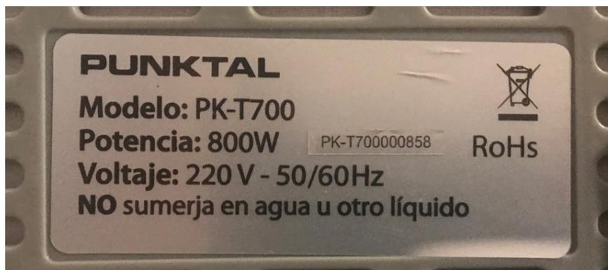
Para poder realizar el diagrama del circuito, debemos tener los valores de todas las variables necesarias, en este caso intensidad de corriente y voltaje para calcular la resistencia. En este caso calcularemos la corriente a partir del Efecto Joule, y luego con esta calcularemos la resistencia a partir de la Ley de Ohm, teniendo en cuenta las variables dadas de **potencia (800W)** y **voltaje (220V)**.
