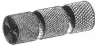
Este mecanizado, denominado *moletado*, se realiza sin arranque de viruta con la ayuda de unos rodillos llamados *moletas*. Estas se fabrican en acero templado de gran dureza, y llevan talladas en su superficie exterior las estrías que deberán grabar al rodar a gran presión sobre la superficie que se ha de moletar.
