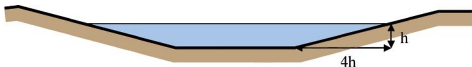
Figura 8. Perfil transversal del vertedero de máximas
