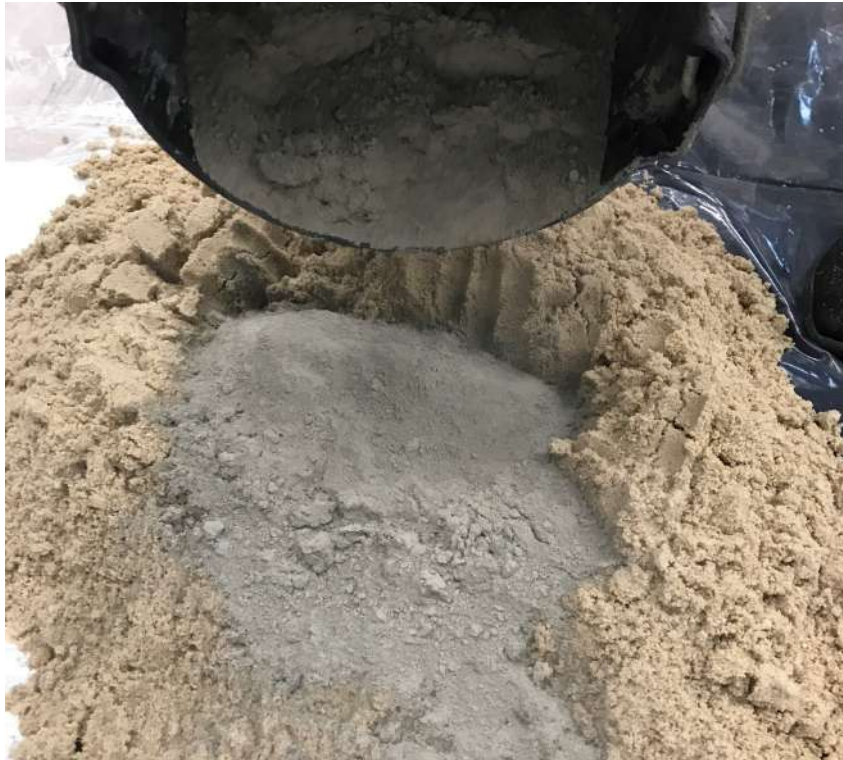
Figura 4.1: Mezcla de arena y portland.
