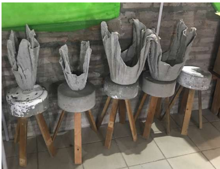
Figura 4.9: Objetos en hormigón ya desencofrados, listos para usar.
