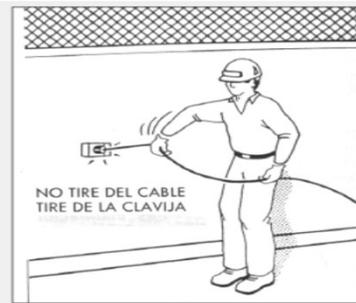
NO TIRE DEL CABLE TIRE DE LA CLAVIJA
