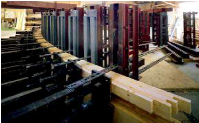
Figura 8: Curvado de vigas de MLE. Fuente: N'H International (2021).
