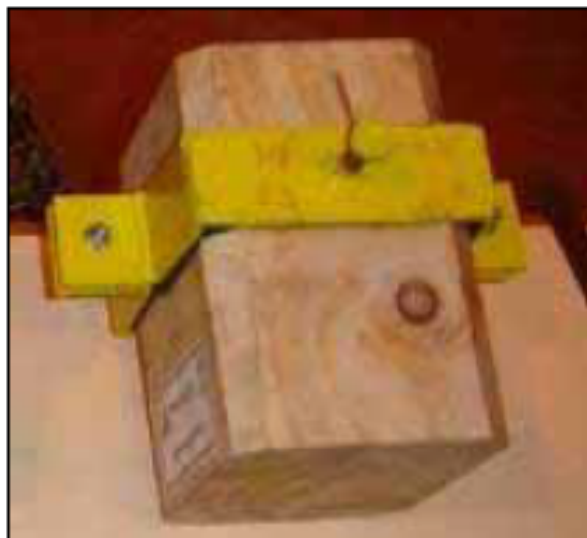
Figura 15: Probeta con perfil metálico. Fuente: Faggiano, Marzo, Mazzolani, Calado (2016).
