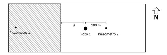
Se pide calcular la distancia de la barrera al pozo de bombeo d a partir de un ensayo de bombeo realizado con un caudal de 480 m3/d.
