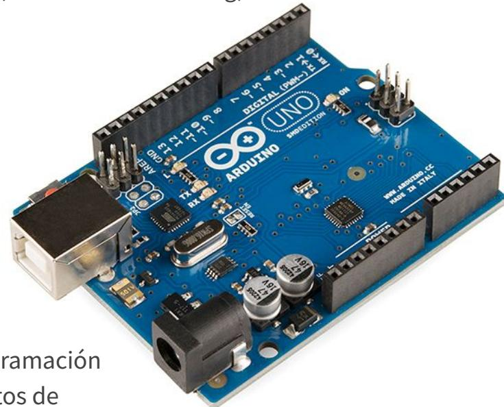
Arduino se enfoca en acercar y facilitar el uso de la electrónica y programación de sistemas embebidos en proyectos multidisciplinarios. Los proyectos de Arduino pueden ser autónomos o se pueden comunicar con software en ejecución en la computadora (por ejemplo con *Flash*, *Processing*, *MaxMSP*, etc.).
