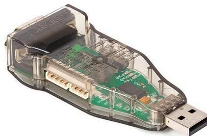
**Figura 3: Módulo USB U2D2 de Robotis**
