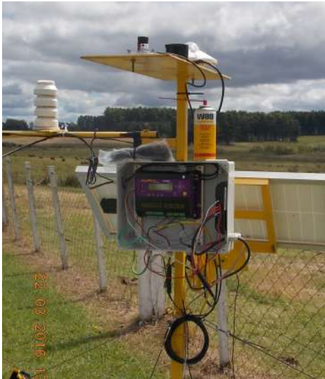
Tacuarembó, INIA La Magnolia GHI CMP11 GHI redundante Licor 200 GTI Licor 200 TA (Pt1000)
