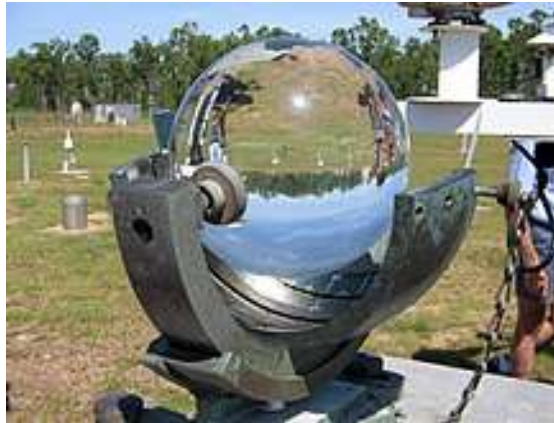
Heliógrafo de Campbell-Stokes: registra heliofanía quemando un trazo sobre una banda de papel especial.
