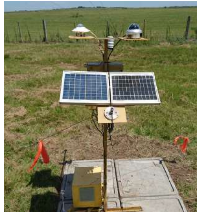
Artigas (INUMET; Aeropuerto) GHI (KZ CMP10) GHI redundante (SPN1) DHI (SPN1) GTI Licor 200 TA (Pt 1000)
