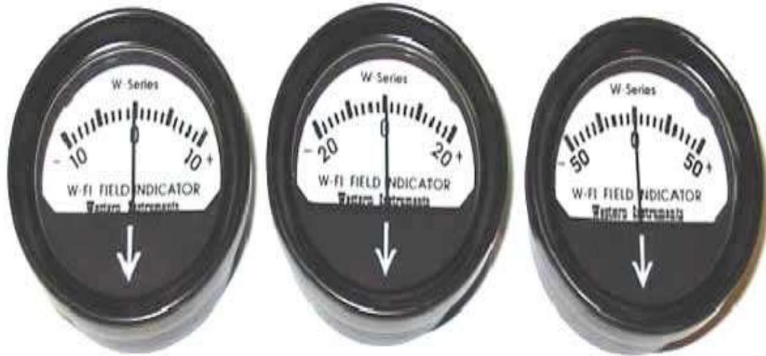
Medidor de campo residual: instrumento para medir campo magnético.
