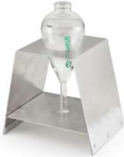
Tubo Centrifugo : para medir la concentración de las partículas en el baño.
