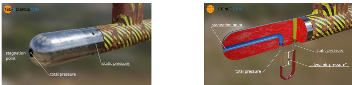
Figura 19: Tubo de Pitot bajo el ala de un avión.
