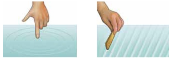
Figura 2: Dos tipos diferentes de perturbación generan dos formas de onda diferentes. Una fuente puntual genera ondas circulares, mientras que un objeto rectilíneo produce ondas planas.
