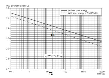
La curva a utilizar se debe interpolar entre las 2 disponibles (con y sin "prior duty") teniendo en cuenta la proporción de E a la energía (térmica o single impulse) en base a la cuál se elaboró la curva "con prior duty".
