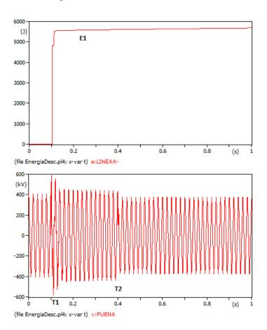
Sea T1 el período de tiempo hasta que se estabiliza la energía, T1+T2 el período total de estudio y E la energía total inyectada (que es igual a la energía total inyectada hasta T1), supuesta no mayor que la single impulse.
