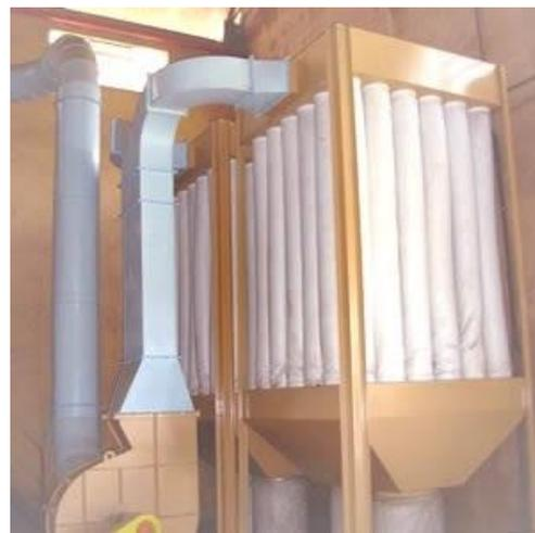
Figura 12.4 Filtro de mangas. Tomado de: <https://deproinsa.com.ec/proyectos-industriales/filtro-de-mangas/> y [https://upload.wikimedia.org/wikipedia/commons/1/1e/Filtro de Mangas.jpg](https://upload.wikimedia.org/wikipedia/commons/1/1e/Filtro_de_Mangas.jpg)
