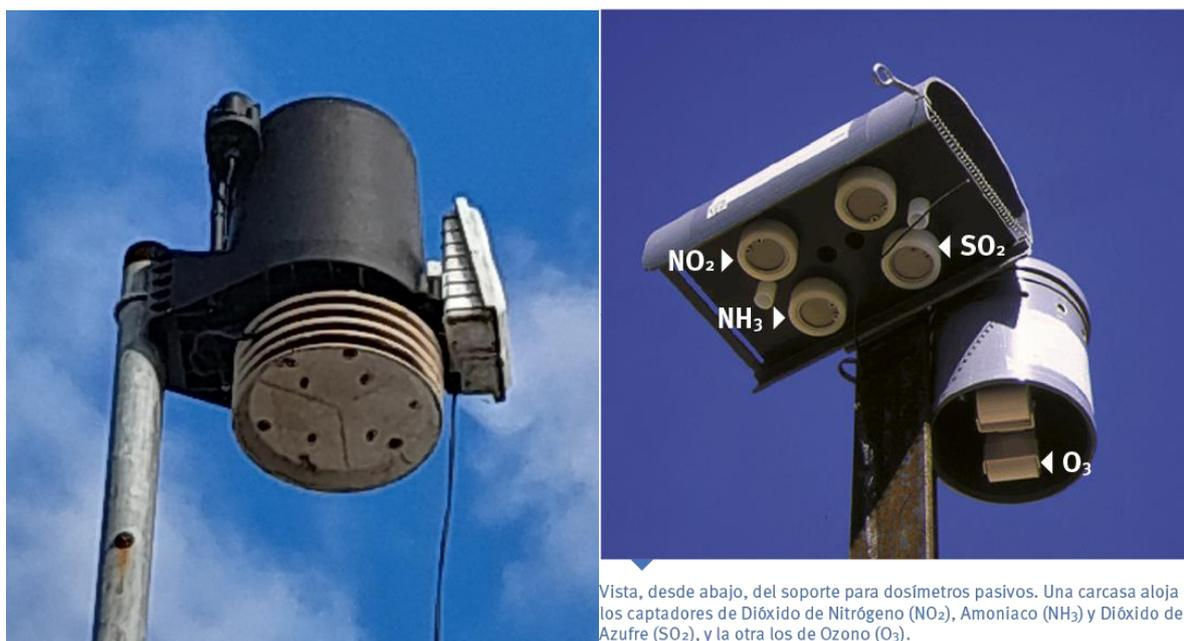
Figura 10.11 Monitor pasivo para contaminantes atmosféricos. Der.: tomado de
