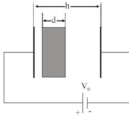
a) Halle el campo eléctrico  $\vec{E}$  en todo punto de la región entre las placas y la carga  $Q$  en las placas (en valor absoluto).
