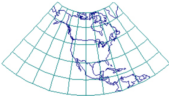
Figura 9.6. Proyecciones cónica conforme de Lambert (a) y cónica equivalente de Albers (b).
