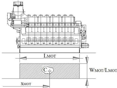
Fig. 6 - Distribución de pesos localizados: Motor Principal
