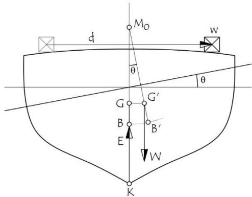
Fig. 9 - Efecto del movimiento horizontal de pesos
