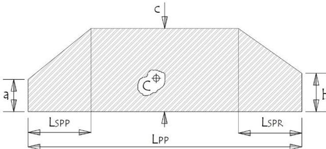
Fig. 3 - Modelo trapezoidal de distribución de acero del casco
