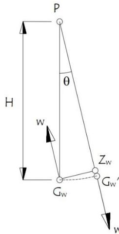
Fig. 16 - Esquema del traslado del centro de gravedad del peso suspendido
