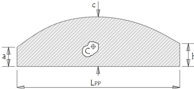
Fig. 4 - Modelo parabólico de distribución de acero del casco
