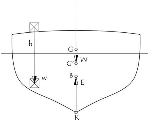
Fig. 10 – Efecto del movimiento vertical de pesos
