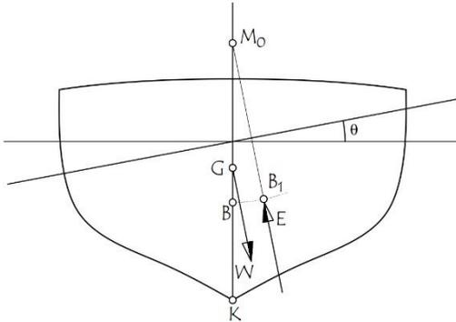
Fig. 8 - Esquema dinámico durante el balanceo de un casco
