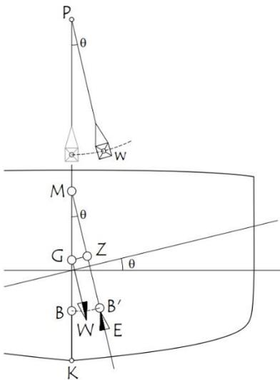
Fig. 15 – Oscilación del buque con peso suspendido
