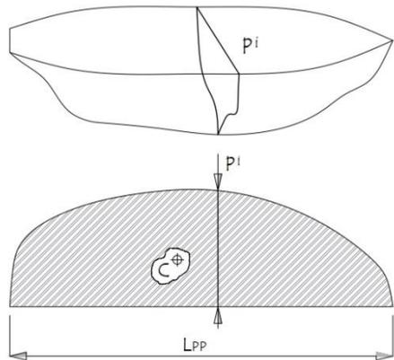
Fig. 5 - Distribución de peso según el perímetro de las estaciones
