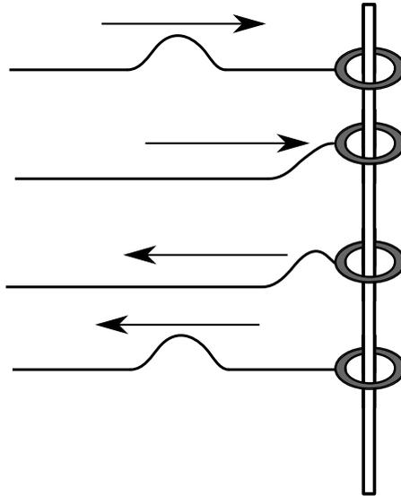
La argolla permite que el punto suba y baje sin fuerza externa. Eso es posible eliminando el rozamiento vertical y por lo tanto, en ese punto la barra no ejerce fuerza vertical sobre la cuerda. El pulso rebotará con *la misma forma*, ya que solamente fuerzas horizontales actúan sobre la cuerda. Si  $f(x - vt)$  representa la onda incidente,  $f(x + vt)$  representa la onda que rebota.
