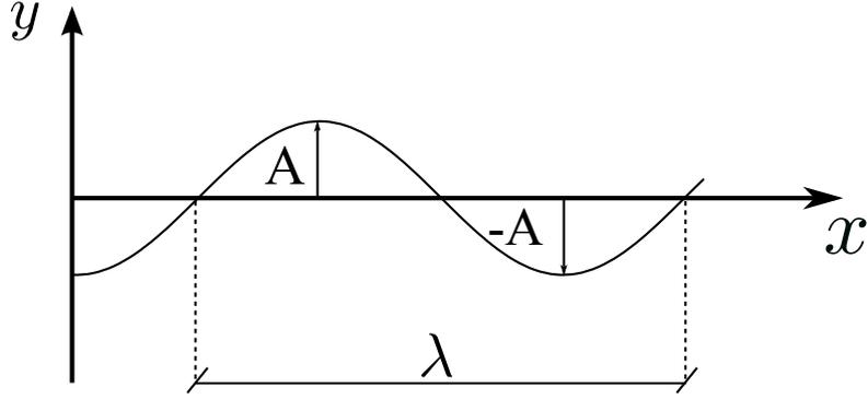
Figura 5: Diagrama de una onda sinusoidal con un desfase. Representación de la longitud de onda  $\lambda$ .
