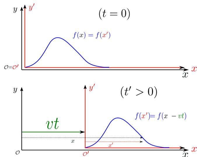
Figura 4: Pulso descrito por dos referenciales diferentes. Para  $t = 0$ , ambos referenciales coinciden (desplazados en la figura para mejor visualización). Después de un tiempo  $t$ , el pulso se desplazó una distancia  $D = vt$ , pero en el referencial  $\mathcal{O}'$  se mantiene inalterado.
