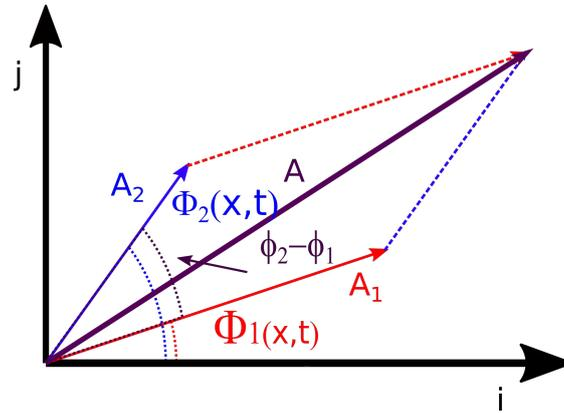
Figura 13: Diagrama de fasores para representar ondas armónicas.
