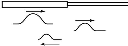
Figura 9: Diagrama de una onda propagándose en una cuerda que cambia de un medio densidad alta hacia a uno de densidad menor. Una parte (mayor) es transmitida; la parte reflejada tiene la misma fase.
