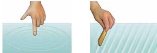
Figura 2: Dos tipos diferentes de perturbación generan dos formas de onda diferentes. Una fuente puntual genera ondas circulares, mientras que un objeto rectilíneo produce ondas planas.
