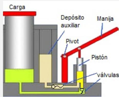
**Sistema mecánico:** Una fuerza  $F'_1$  vertical hacia abajo aplicada en el extremo de la manija produce un torque respecto del pivote. Ese mismo torque se traduce en una fuerza  $F_1$  vertical hacia abajo sobre la barra vertical (y sobre el pistón) que se encuentra más cerca del pivote. Considerando las distancias horizontales  $d'_1$  y  $d_1$  al pivote, el torque verifica:  $\tau = F'_1 d'_1 = F_1 d_1$ . La fuerza sobre el pistón se multiplica  $F_1 = 10 F'_1$  cuando  $d'_1 = 10 d_1$ .
