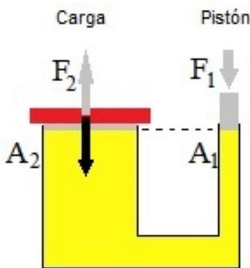
Figura 4: Máquina hidráulica (Esquema)
