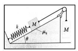
Un bloque de masa M descansa sobre un plano inclinado. Se sujeta a un muro con un resorte cuya constante elástica es k. Mediante una cuerda se une este bloque con otro bloque colgante de masa M, pasando por un soporte sin fricción como se muestra en la figura. Si el coeficiente de fricción estática entre el bloque y la rampa es  $\mu$ , ¿para qué rango de valores de estiramiento del resorte permanece el sistema en equilibrio?
