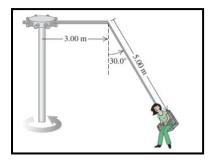
El "columpio gigante" de un parque de diversiones consiste en un eje vertical central con varios brazos horizontales unidos a su extremo superior. Cada brazo sostiene un asiento suspendido de un cable de 5.00m sujeto al brazo en un punto a 3.00m del eje central.
