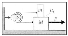
Una caja de masa m=5.0kg descansa sobre una caja mayor, de masa M=25kg que a su vez descansa sobre una superficie sin fricción. El coeficiente de fricción estática entre las dos cajas es  $\mu_s=0.45$ . Una cuerda ideal está unida en sus extremos a ambas cajas pasando por una polea fija y sin masa, como se ve en la figura. ¿Cuál es la fuerza F máxima que se puede ejercer sobre la caja inferior sin que las cajas deslicen?
