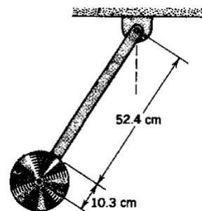
**Nota:** Un péndulo simple tiene la masa total concentrada en el extremo del péndulo, siendo despreciable la masa de la barra que la sostiene.
