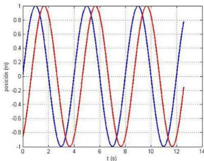
1. La figura muestra la posición en función del tiempo de dos objetos. Si el gráfico azul representa  $x_1(t) = x_0 \text{ sen}(\omega t)$ , el gráfico rojo representa  $x_2(t) = x_0 \text{ sen}(\omega t + \pi/3)$ .
