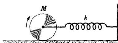
energía cinética de rotación del cilindro al pasar por la posición de equilibrio. (c) Demuestra que en estas condiciones el centro de masa del cilindro efectúa un movimiento armónico
