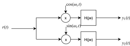
Las señales  $x_1(t)$  y  $x_2(t)$  se consideran de banda limitada con frecuencia máxima  $\omega_M$ , de manera que  $X_1(j\omega) = X_2(j\omega) = 0$  para  $|\omega| > \omega_M$ . Se da por sentado que la frecuencia de la portadora  $\omega_c$  es mayor que  $\omega_M$ . Demostrar que  $y_1(t) = x_1(t)$  y  $y_2(t) = x_2(t)$ .
