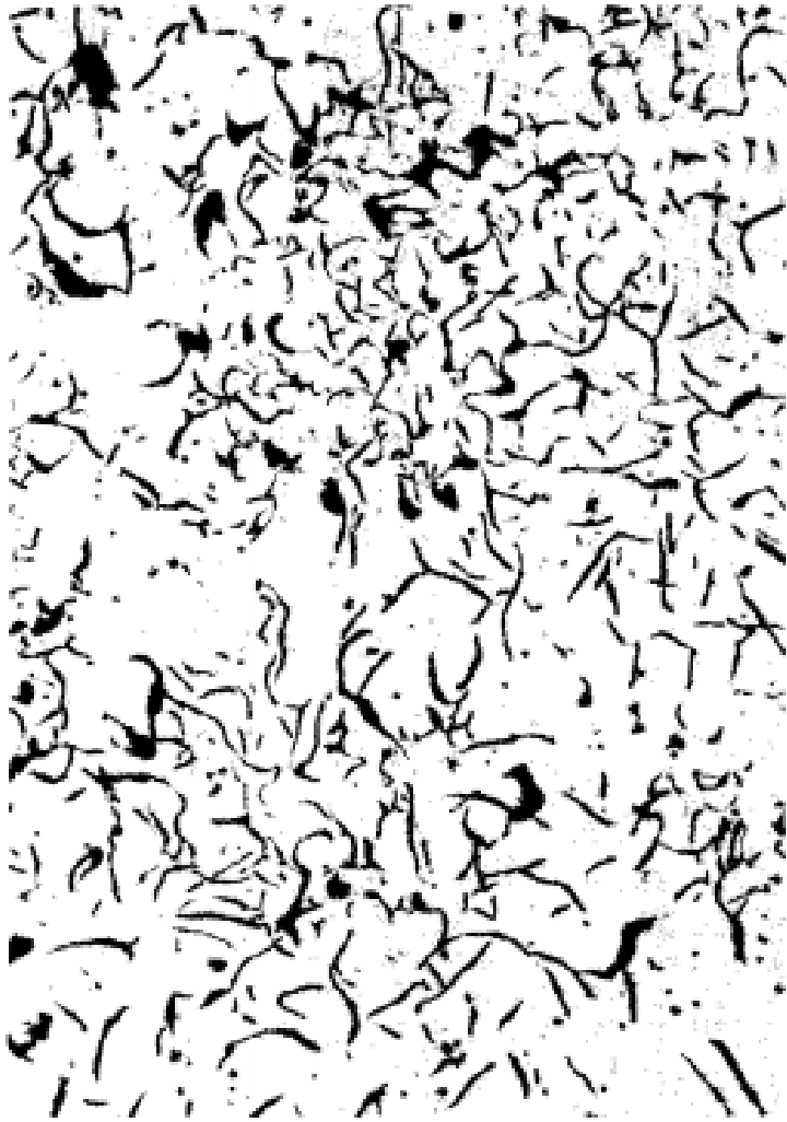
Fig. 11.10 Hojuelas gráficas en un hierro gris fundido. Sin estar atacado químicamente, 100x.
