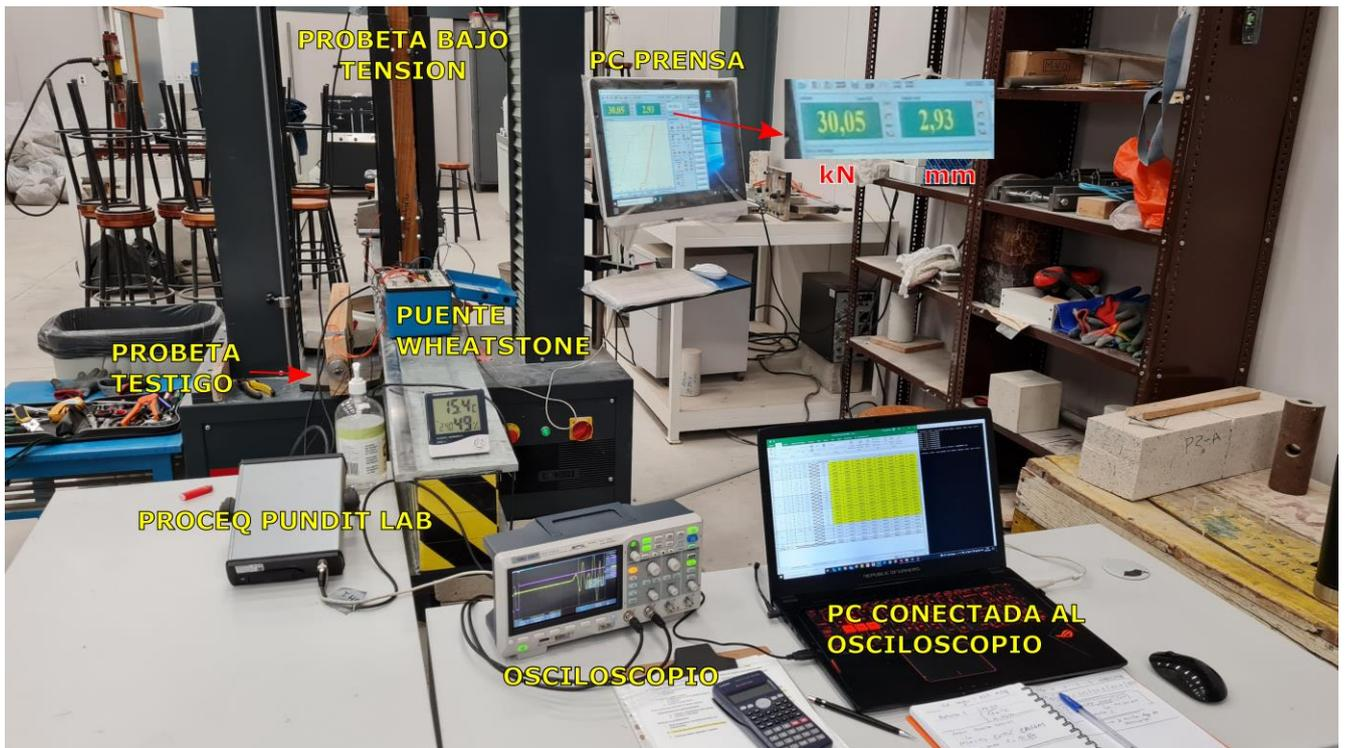
Figura 4: Esquema de ensayo montado en laboratorio. Durante un ensayo.
