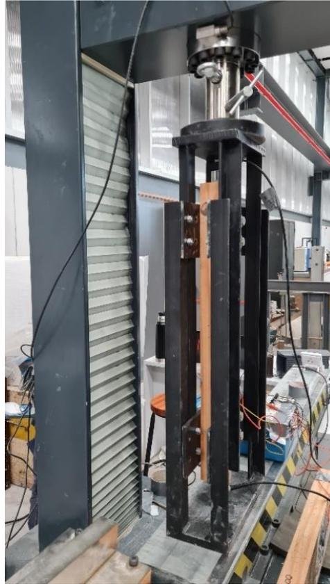
Figura 16: Herraje con la probeta, colocado en la prensa.
