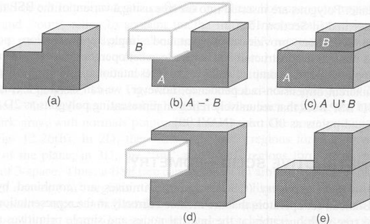
El objeto presentado en (a) se puede definir con varias operaciones CSG, como se ilustra en (b) y (c). El ajuste fino hacia arriba de la cara superior de (b) y (c) produce objetos diferentes, presentados en (d) y (e).
