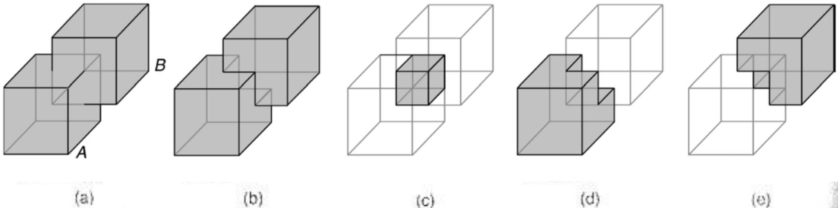
Operaciones booleanas. (a) Objetos  $A$  y  $B$ , (b)  $A \cup B$ , (c)  $A \cap B$ , (d)  $A - B$  y (e)  $B - A$ .
