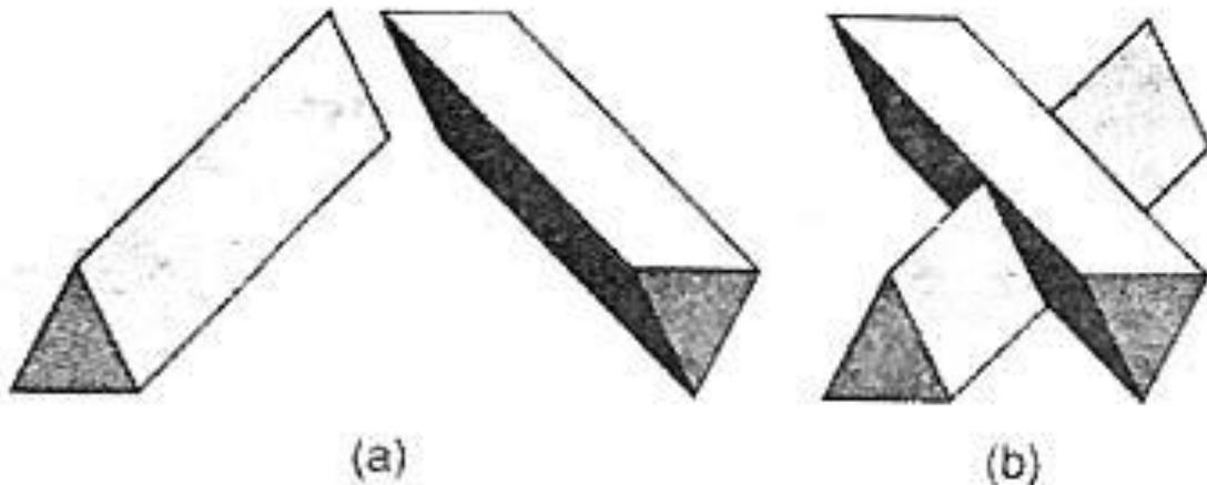
(a) Dos barridos simples de objetos bidimensionales (triángulos). (b) La unión de los barridos presentados en (a) no es un barrido simple de un objeto bidimensional.
