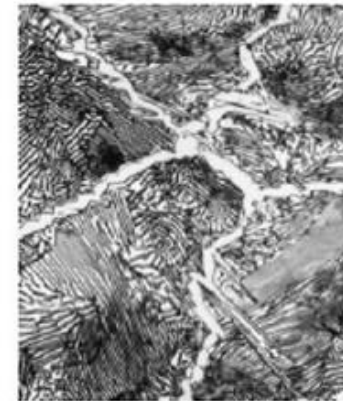
Figura 14.0 Microestructura de un acero con 1,4% C, formado por cementita proeutectoide blanca, reticulada alrededor de las colonias de perlita.
