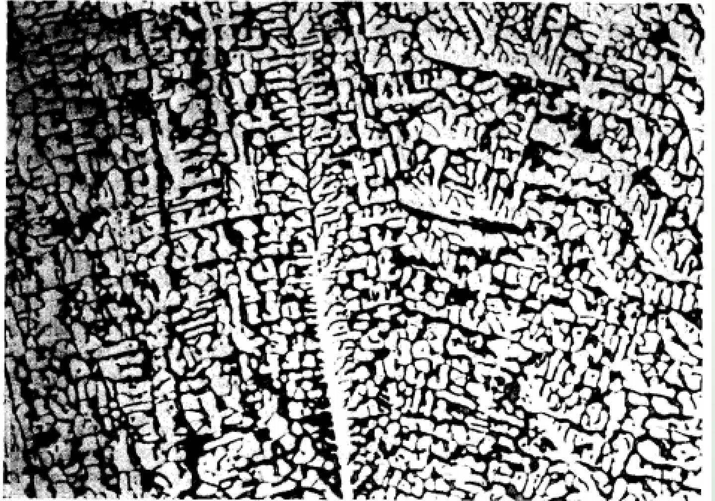
Fig. 6.10 Dendritas finas segregadas químicamente en una aleación cobre-plomo; ampliación 100x. (Research Laboratories, National Lead Company.)
