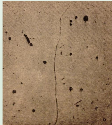
Fig. 6.12 Fotomicrografía de una aleación 85 Cu-15 Ni: a) colada en un molde frío, 50x; b) colada en un molde frío, recalentada 3 hr a 1382°F, 50x; c) colada en un molde frío, recalentada 9 hr a 1742°F, 50x; d) colada en un molde caliente; 50x; e) colada en un molde caliente, recalentada 15 hr a 1742°F, 50x. (Con autorización de Brick, Gordon, and Phillips, "Structure and Properties of Alloys", 3a. ed., McGraw-Hill Book Company, Nueva York, 1965.)
