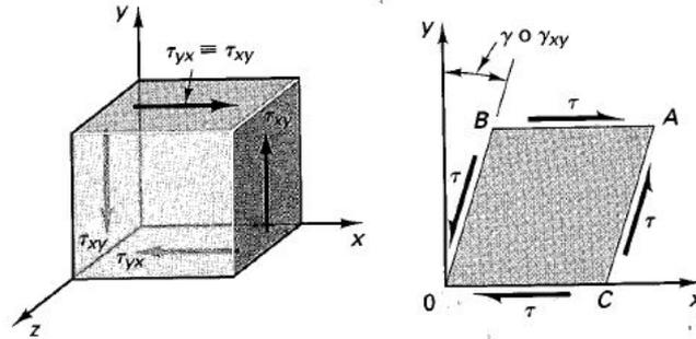
Si pensamos en un elemento diferencial, sometido solamente a esfuerzos cortantes, podemos observar que el mismo no se “estira” sino que se “distorsiona”. Para estos casos, la variable deformación será la **deformación angular ( $\gamma$ )** y definirá el grado de distorsión angular del elemento.
