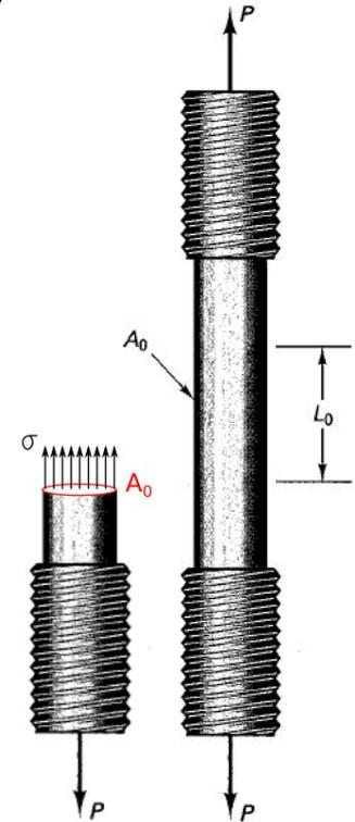
**Esfuerzo de fluencia ( $\sigma_y, S_y$ ):** Esfuerzo máximo que soporta el material antes de entrar en la zona de fluencia. En la gran mayoría de los casos en los que se desea diseñar o evaluar una pieza, se considera que una pieza falla cuando alcanza  $\sigma_y$ , por lo tanto siempre deberemos estar por debajo de este valor.
