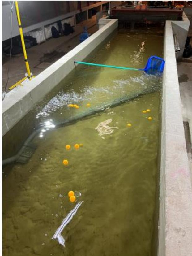
**Figura 6-5. Prototipo de barrera de burbujas elaborado y ensayado por estudiantes de ingeniería mecánica en el laboratorio del IMFIA para su proyecto de grado en 2023. Tomado de: R. Carissimi, M. Izquierdo, N. Sabjan (2023)**
