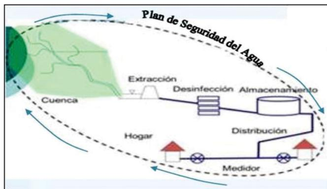
Figura 3.3. Plan de Seguridad del Agua.
