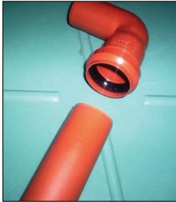
Figura 7.14. *Junta elástica.*
