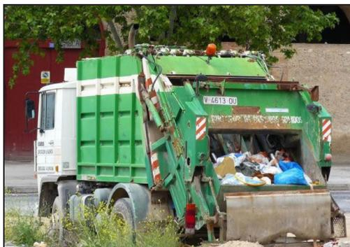
Figura 6.4. *Camión compactador.*
