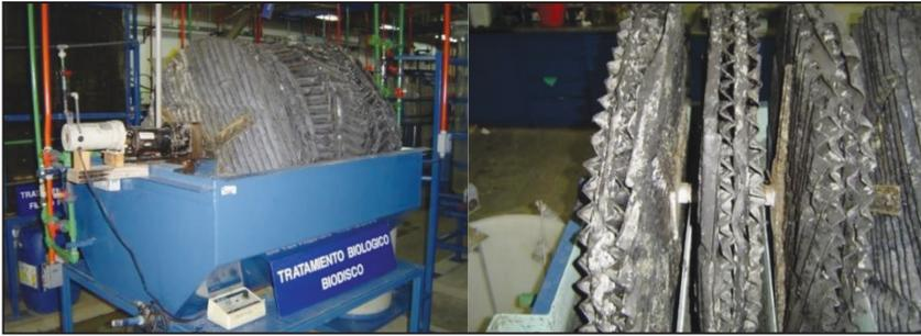
Figura 5.15. *Piloto de biodiscos.*
