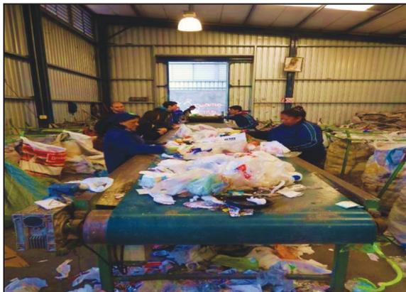
Figura 6.8. Separación de residuos en cinta clasificadora.
