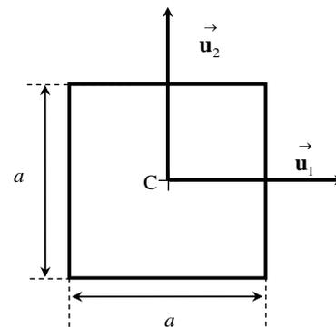
a) Calcule los momentos de inercia de la pieza respecto a las rectas que pasan por el centro C de la placa y son paralelas a los lados ( $C\vec{u}_1$  y  $C\vec{u}_2$  en la figura).
