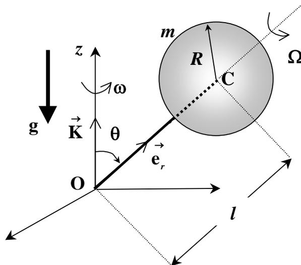
Se supondrá que el sistema gira con nutación  $\theta$  constante, que la velocidad angular de la barra alrededor de  $Oz$  es  $\omega$  y la velocidad angular de la esfera relativa a la barra es  $\Omega$ . Ambas velocidades angulares,  $\omega$  y  $\Omega$ , son constantes.
