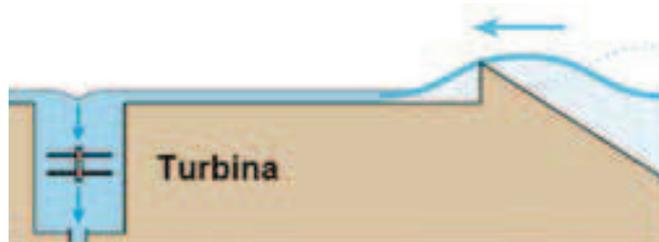
Figura 7 - Esquema de funcionamiento del Dispositivo de Sobre-pasamiento.
