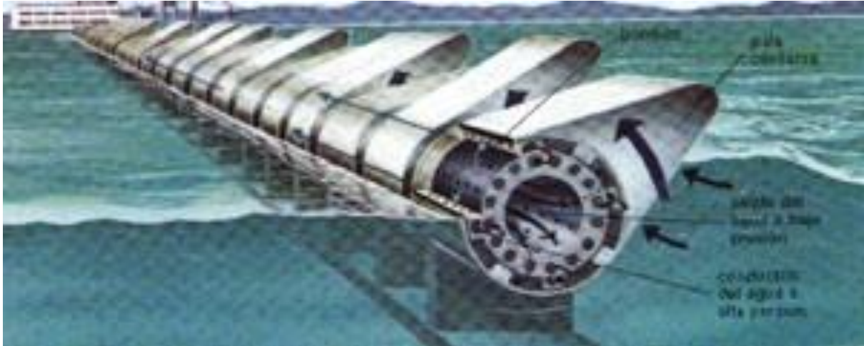
Fig. 11 - Generador Mareomotriz de Presa de Marea
