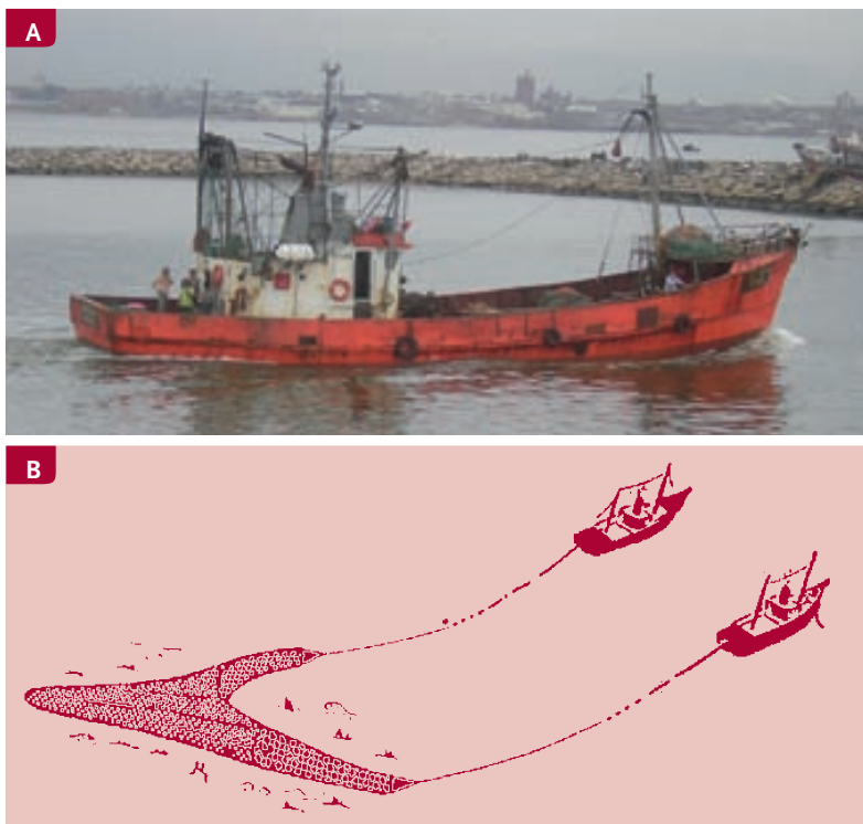
FIGURA 9. a) Barco industrial de la flota costera uruguaya y b) esquema de la modalidad de pesca en parejas, muy utilizada por la flota industrial de arrastre costero.
