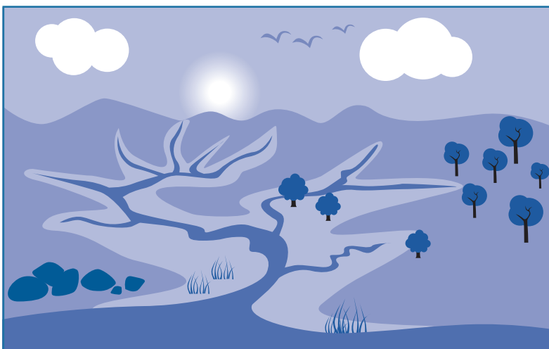
FIGURA 5. Componentes de una cuenca. Las partes altas funcionan como divisorias de agua, generando las nacientes que darán lugar a cursos de agua cada vez mayores.
