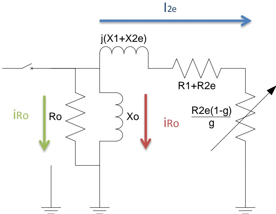
Se pide determinar:  $n_s$  (rpm de sincronismo),  $gn$  (deslizamiento en condiciones nominales),  $Pabsn$  (potencia absorbida),  $Qabsn$  (reactiva absorbida),  $Ro$ ,  $Xo$ ,  $R1$ ,  $X1 + X2e$ ,  $R2e$ ,  $I2en$  (corriente rotórica pasada al estator),  $In$  (corriente nominal),  $Cn$  (par nominal),  $CA$  (par de arranque).
