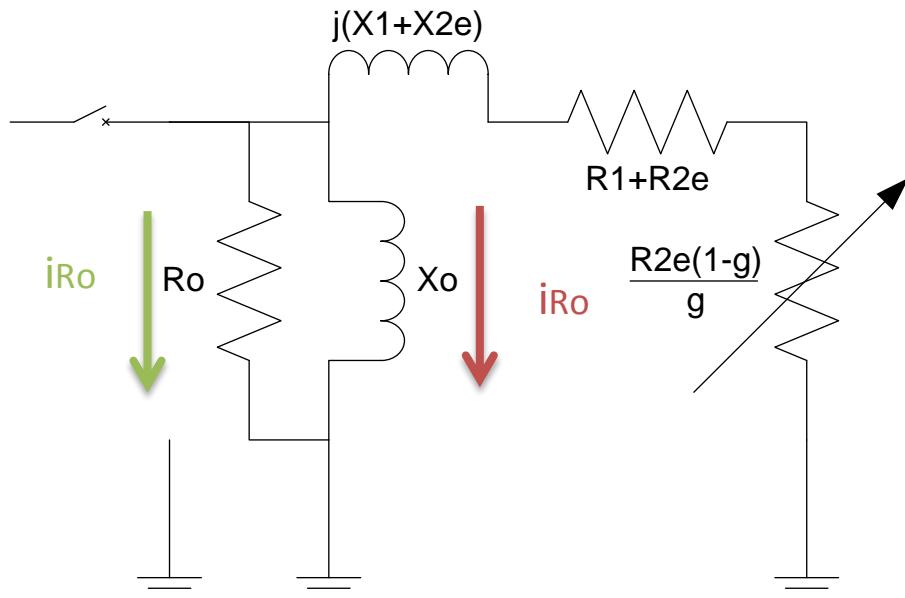
Se pide determinar:  $n_s$  (rpm de sincronismo),  $g_n$  (deslizamiento en condiciones nominales),  $P_{absn}$  (potencia absorbida),  $Q_{absn}$  (reactiva absorbida),  $R_o$ ,  $X_o$ ,  $R_1$ ,  $X_1 + X_{2e}$ ,  $R_{2e}$ ,  $I_{2en}$  (corriente rotórica pasada al estator),  $I_n$  (corriente nominal),  $C_n$  (par nominal),  $CA$  (par de arranque).
