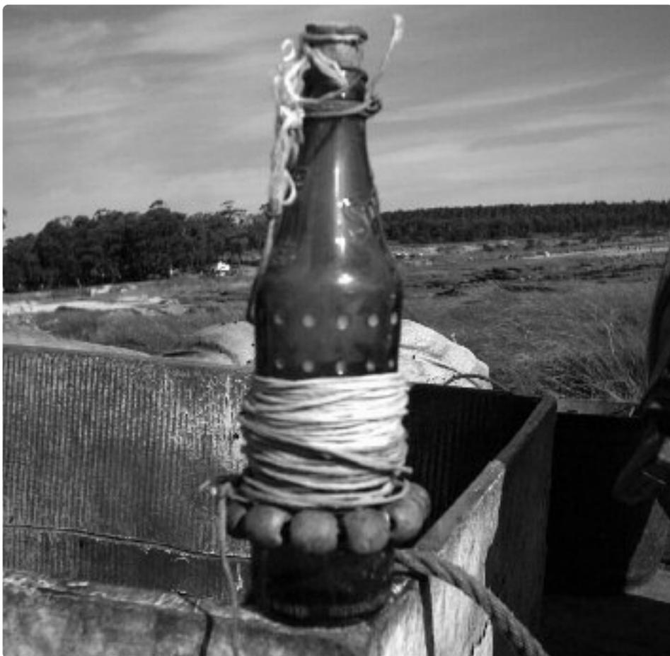
Figura 86. Probador empleado por los pescadores artesanales de Pajas Blancas para determinar la salinidad de las aguas de fondo para localizar el cardumen de corvina (*Micropogonias furnieri*) (Pajas Blancas, Montevideo).
