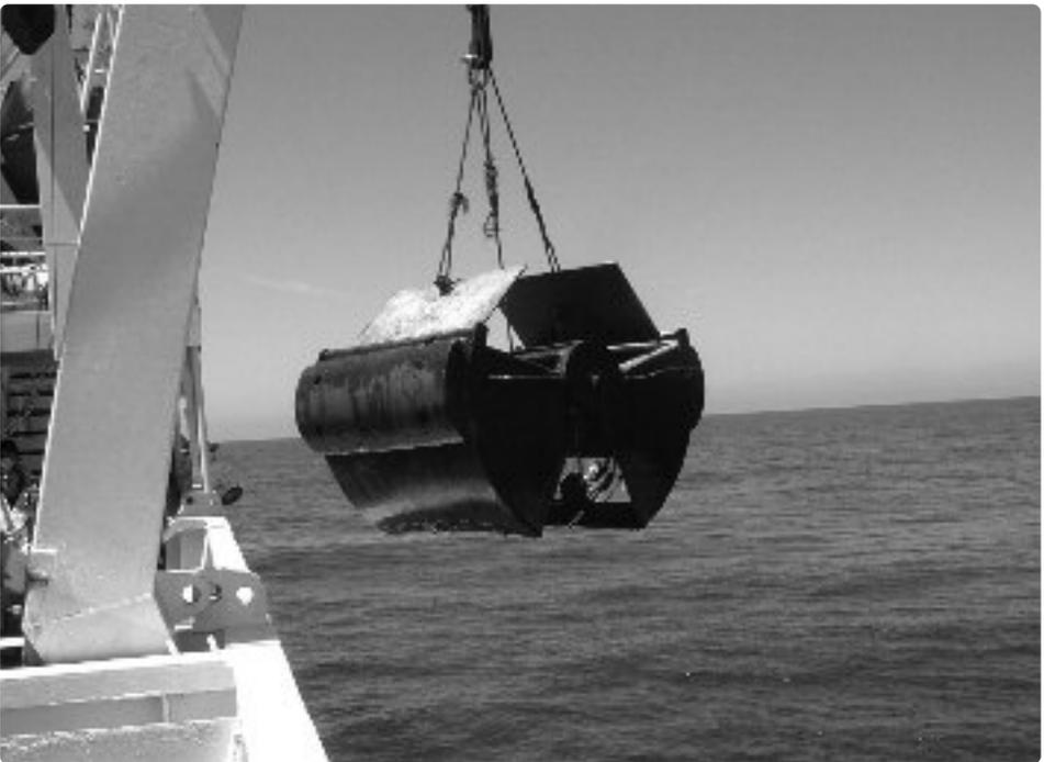
Figura 38. Draga empleada para la obtención de muestras de sedimentos blandos a los efectos de conocer la fauna que compone la comunidad bentónica.
